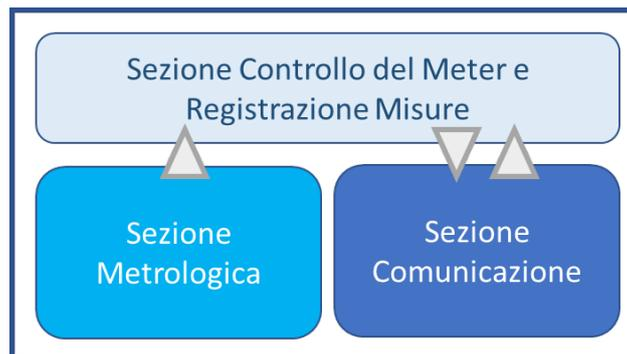
Figura 1 - Schema a blocchi contatore idrico
