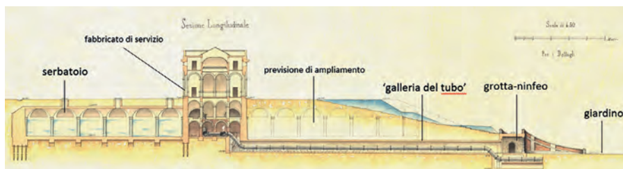
Fig. 14. E. CORSI, Sezione longitudinale , 1873-1876 (ASFi, CF DIS, car n.n.; su concessione dell'Archivio storico del Comune di Firenze)
